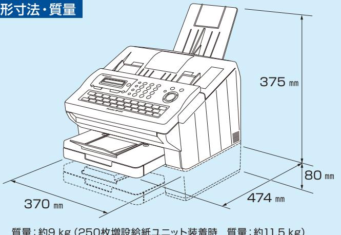
質量：約9 kg (250枚増設給紙ユニット装着時 質量：約11.5 kg)
